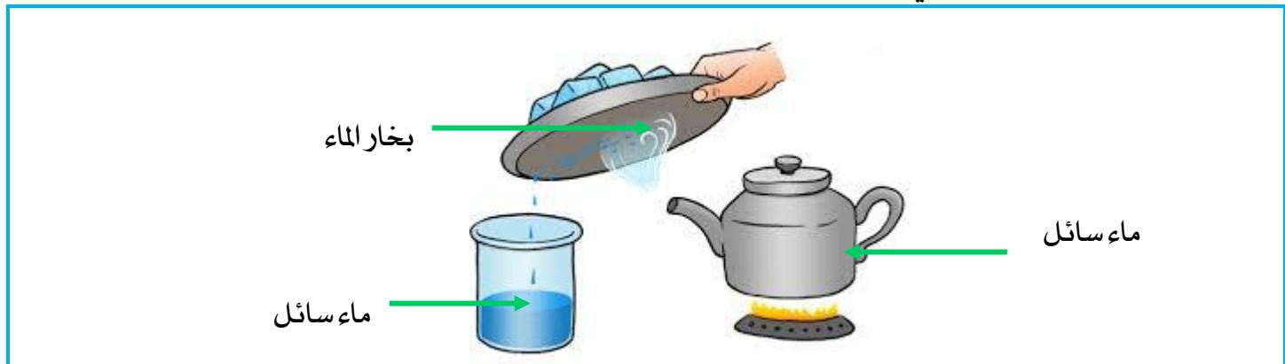
الملاحظة: عند الغليان تصاعد بخار الماء أي تحول الماء السائل إلى الحالة الغازية وعند اعتراض البخار بصفحة باردة تتشكل قطرات مائية تسقط في الكأس أي: تحول بخار الماء (حالة غازية) إلى الحالة السائلة
